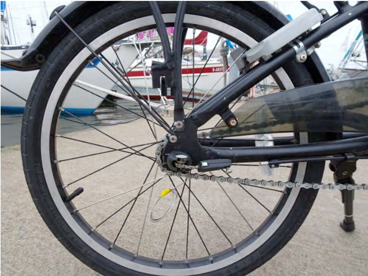
Am Bordfahrrad habe ich 6 gebrochene Speichen ersetzt. Die Neuen sind unlackiert.
